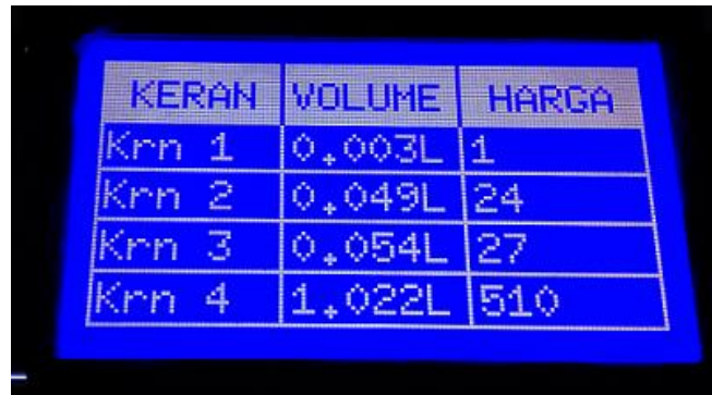
Gambar 5. Layar LCD pada Server yang menampilkan data volume pemakaian air di setiap kamar
