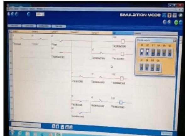
Gambar 2. Diagram Ladder sebagai bentuk instruksi yang digunakan pada PLC
