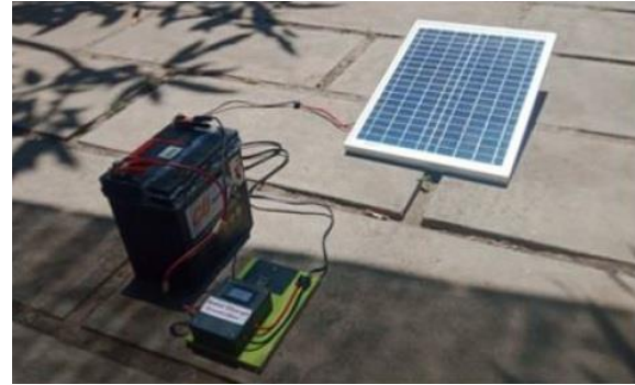
Gambar 3. Pengujian sistem pengisian Baterai
