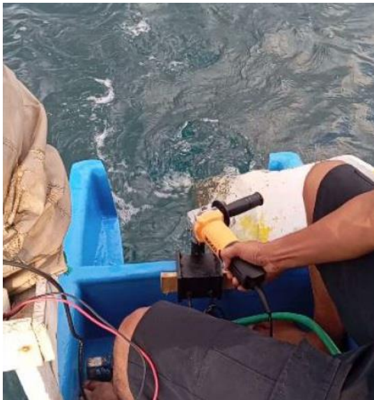
Gambar 13. Perahu berhasil melaju dengan penggerak motor listrik tenaga surya
