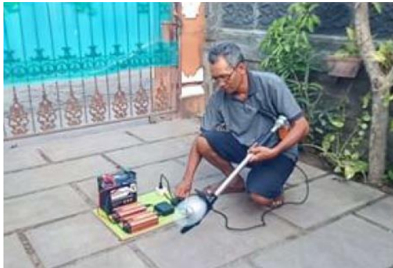
Gambar 5. Pengujian inverter dengan motor listrik
