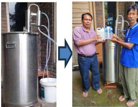
Gambar 1. Penyulingan minyak atsiri sirih hijau.
