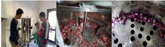
**Gambar 4.** Mesin *Clearner-Sorter* Bawang Merah Bertenaga *Solar Cell*
