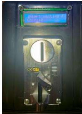
Gambar 12. Posisi Rangkaian Acceptor Coin pada saat Koin tidak Dimasukkan
