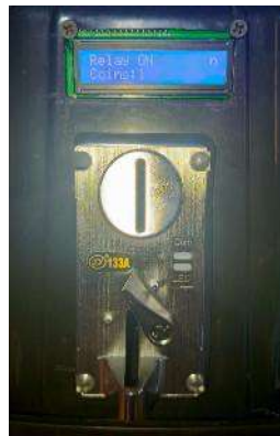
Gambar 13. Posisi Rangkaian Acceptor Coin pada saat Koin Dimasukkan
