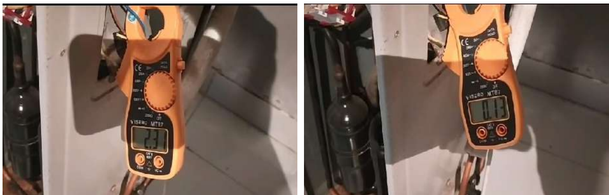
Gambar 6. Kondisi refrigeran kosong: a. arus start tanpa rangkaian, b. arus start dengan rangkaian
