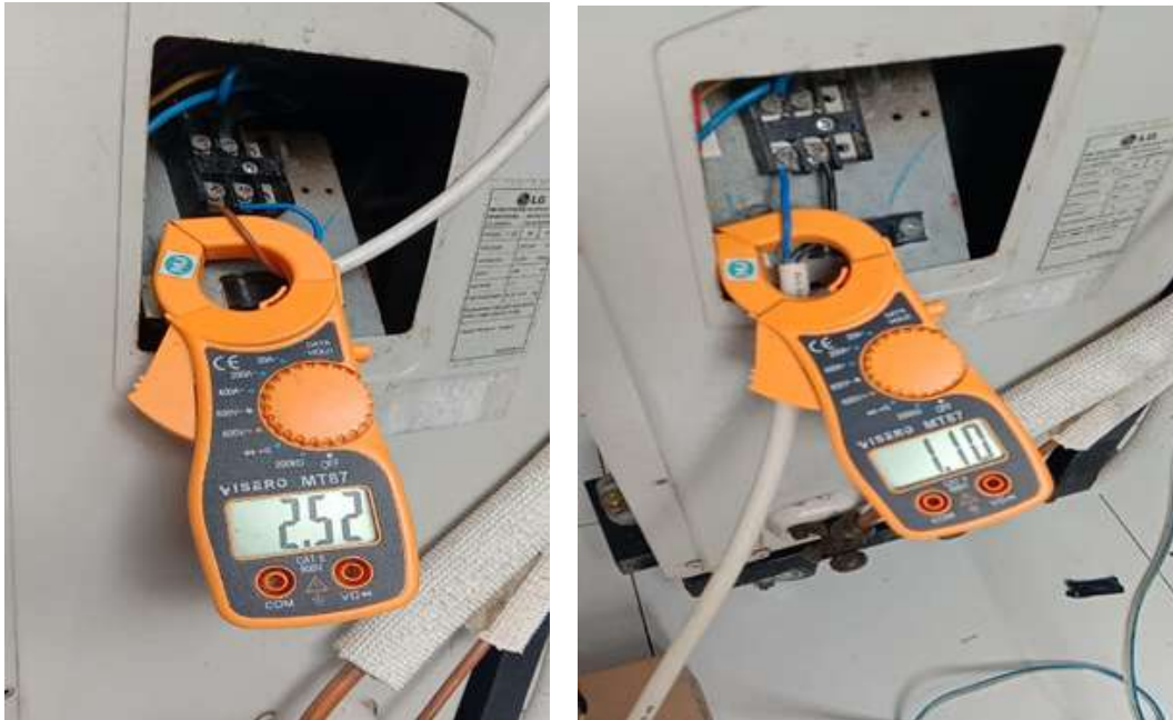
Gambar 7. Kondisi refrigeran tekanan 60psi: a. tanpa rangkaian pencegah lonjakan arus, b. dengan rangkaian pencegah lonjakan arus
