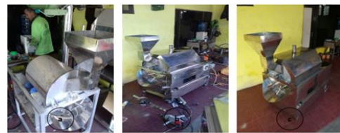
Gambar 4. Pemasangan blok-blok mesin sangrai, (b) pemasangan sistem kontrol dan (c) mesin sangrai siap diuji fungsi.
