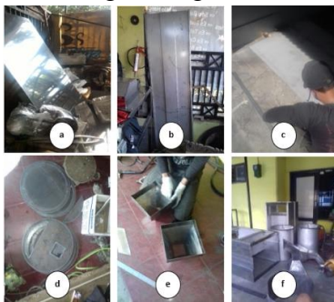
Gambar 3. Proses pembuatan mesin sangrai yang meliputi persiapan bahan (a), pembuatan sketsa (b), pemotongan dan pembentukan blok-blok mesin sangrai (c)(d)(e)(f).
