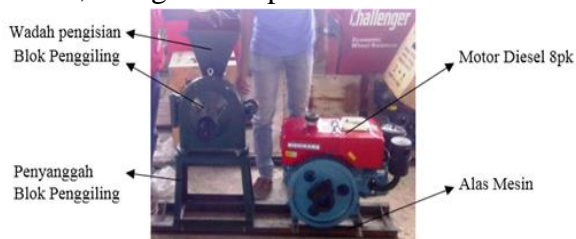
Gambar 6. Bagian mesin penggiling yang dikembangkan untuk pengolahan Kopi Lonsilar Pada Gambar 6, bagian penggiling terdiri atas wadah pengisian, rumah
