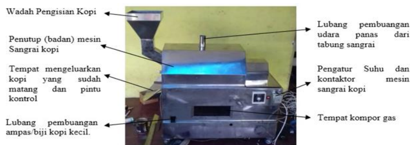
Gambar 2 Mesin Sangrai Kopi berkapasitas 10 kg yang dikembangkan untuk Pengelolaan Kopi Lonsilar di KUD Beringin Apui.
