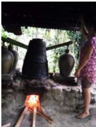
Gambar 2 Alat Penyulingan Arak Bali Tradisional
