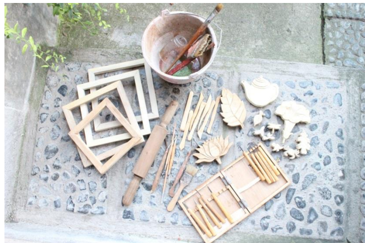
Gambar 2. Acuan cetak kayu dan peralatan pembuatannya
