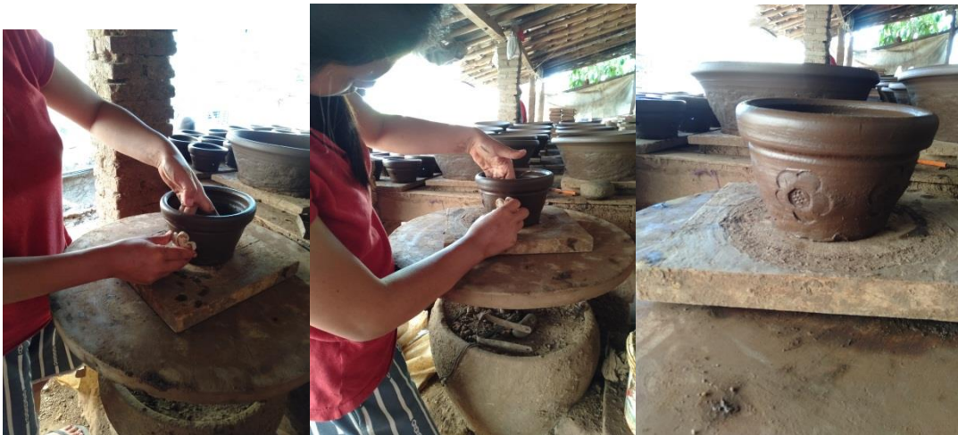
Gambar 2. Prose mencetak dengan acuan cetak relief kayu
